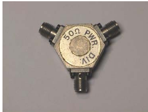
Bild 3: Beispiel eines resistiven Power-Splitters, 0-18 GHz
