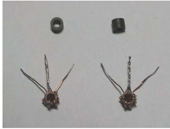
Bild 29: Aufbau des modifizierten 3-dB-Power-Splitters (links) und Ringkerne (rechts)
